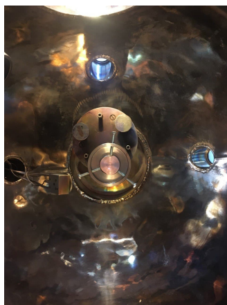
Figura 8. Exemplu de țintă din soluție solidă de HEA8 ( x = 1,6 ), montată în interiorul camerei de reacție, fiind pregătită de a fi iradiată.
