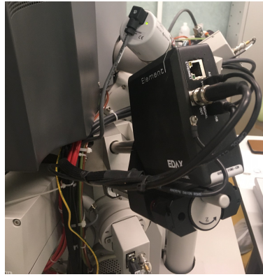
Figura 16. Modulul EDXS utilizat pentru a analiza energia razelor X detectate este atașat la SEM.
