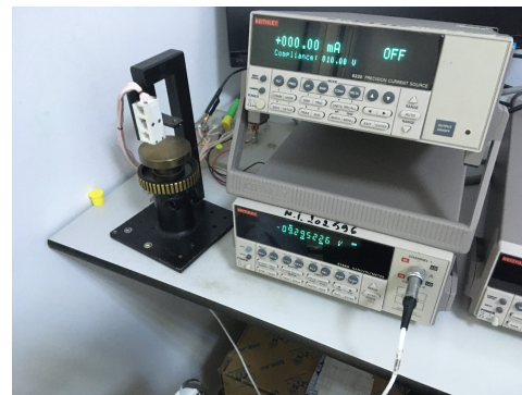
Figura 17. Ilustrația din stânga arată aranjamentul sondei cu patru puncte și inelul de curent generat, importat din [26], în timp ce fotografia din dreapta arată o vedere de ansamblu asupra sistemului de sondă cu patru puncte utilizat. În partea stângă a fotografiei, se poate vedea un suport de probe reglabil, în timp ce în partea dreaptă un ampermetru deasupra unui voltmetru. Pe măsură ce suportul este ridicat, suprafața probei interacționează cu cele patru sonde dispuse pe un rând și conectate două câte două prin cabluri de semnal la cele două instrumente.
