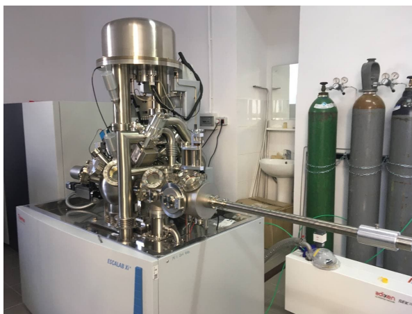
Figura 15. Fotografia din stânga arată o vedere de ansamblu asupra sistemului XPS folosit, în timp ce fotografia din dreapta arată o vedere a unor probe plasate în interiorul spectrometrului.
